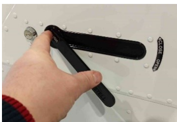
2. Zatlačte na přední část a poté vyklopenou páku otočte dolů.
